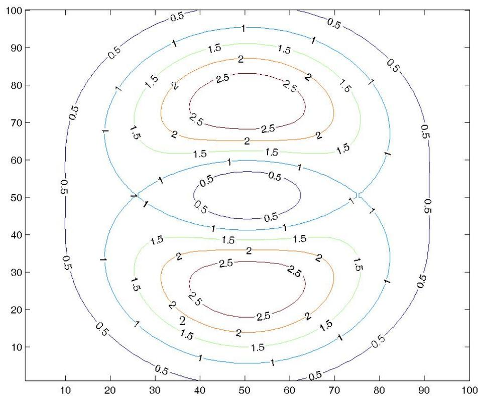
Imágenes de la función interpolante  $g(x, y)$  por el método de Cressman
